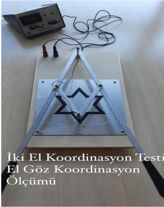
Resim 3: İki El Koordinasyon Testi Ölçüm Cihazı
