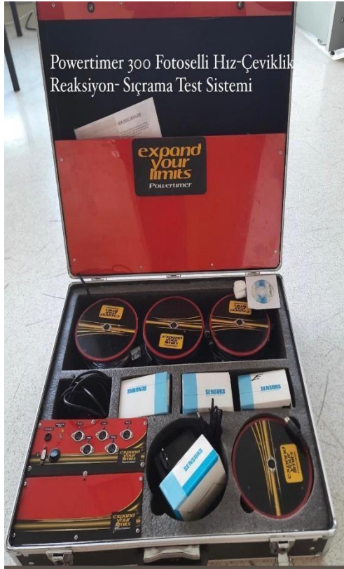
Resim 17: Powertimer 300 Hız-Çeviklik Reaksiyon-Sıçrama Test Sistemi
